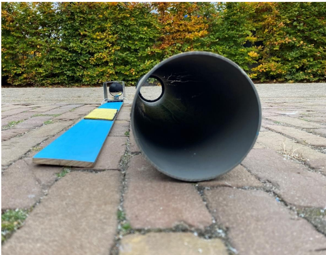
Foto 2.3 Spiegelbuis, de plank met sporenbed, spiegel en klittenband wordt in de buis geschoven..
