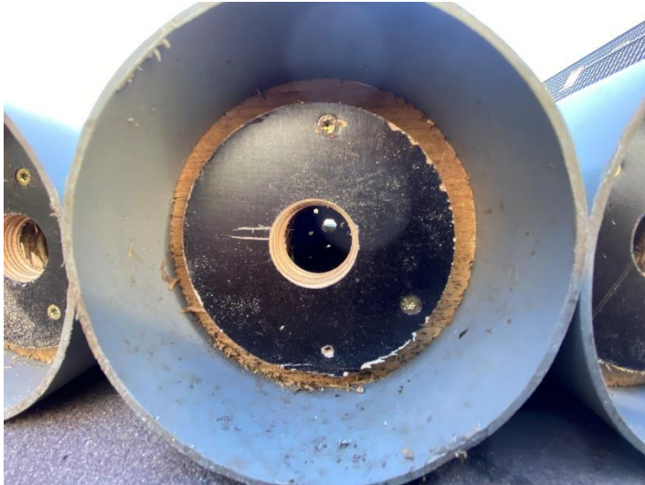
Foto 2.2 Het compartiment van een geurbuis.
